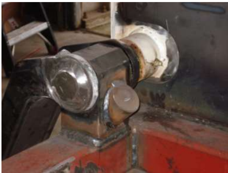
Figuur 11; wig aan lagerblok
