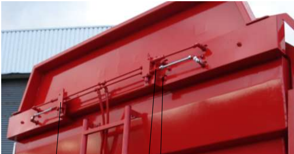
Figuur 5; Montage hydrauliek
