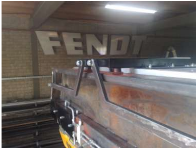
Figuur 10; steun onder stuurarm
